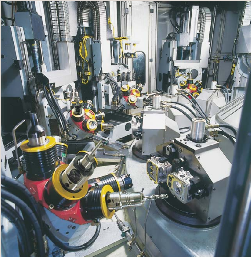
Tourelles revolver sur machine transfert Revolverkopf auf Transfermaschine Revolver head on transfer machine
