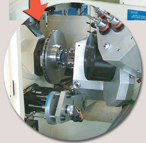
Augmentation du couple par réducteur de vitesse Erhöhung des Drehmoments durch Untersetzungs spindel High torque with speed reduction unit
